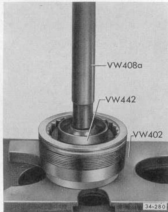
Abb. 14 Dichtring einpressen. AUDI NSU: Einsteckdorn 30-505, Ausdrücker 10-8 und Auspreßwerkzeug 30-509.
