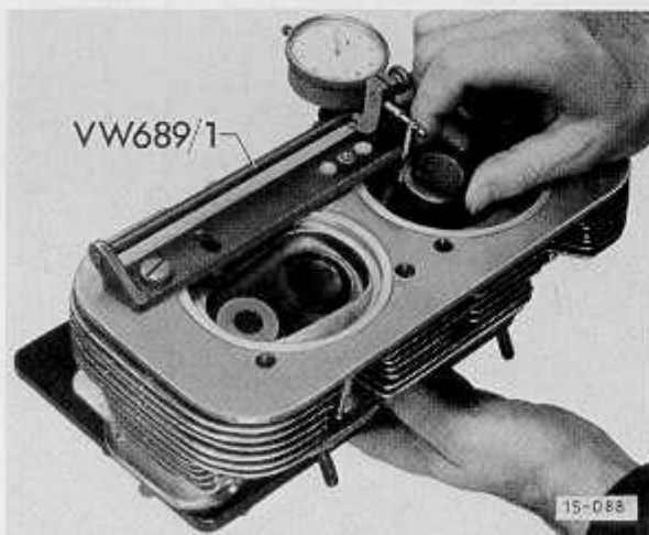
Abb. 14 Ventilführungen prüfen Audi-NSU: VW 387 Kippspiel max. 0,8 mm
