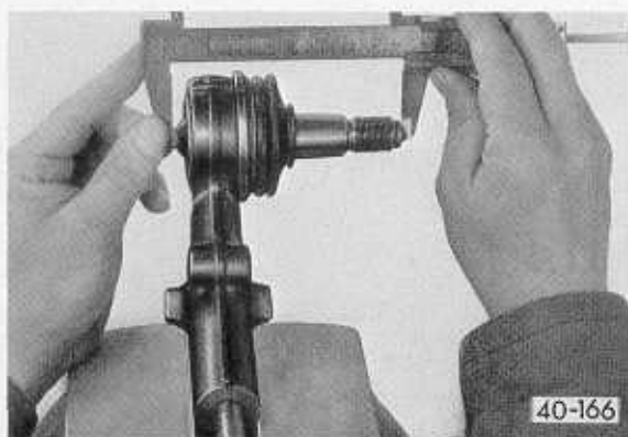
Abb. 8 Achsgelenke prüfen (ausgebaut)
