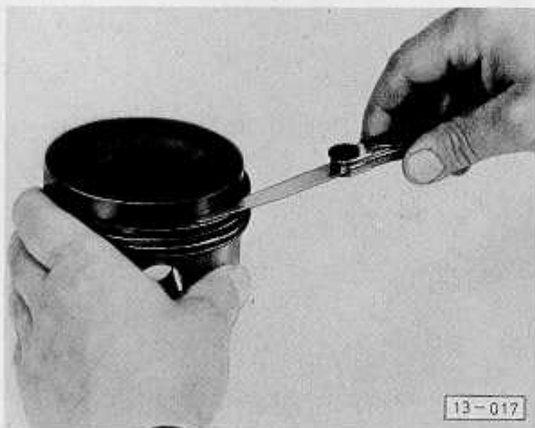
Abb. 4 Kolbenringe – Höhengspiel prüfen
