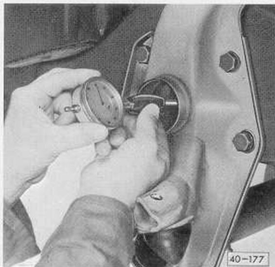
Abb. 20 Verschleiß der Metallbuchse für innere Traghebellagerstelle prüfen
