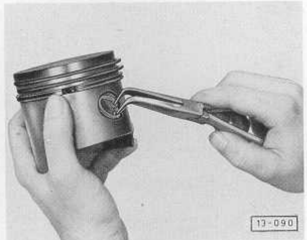
Abb. 4 Sicherungsring aus- und einbauen
