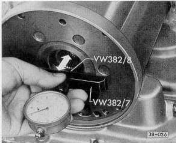
Abb. 6 Axialspiel „x“ des Getriebes messen und einstellen:
