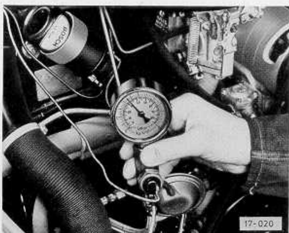
Abb. 5 Öldruck und Öldruckschalter prüfen
