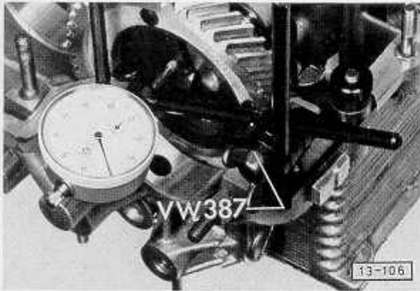
Abb. 2 Nockenwelle – Axialspiel prüfen max. 0,16
