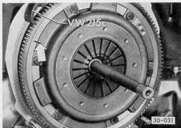
Abb. 1 Kupplung aus- und einbauen Audi-NSU: mit Dorn 10-213 zentrieren
