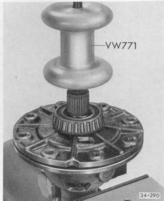
Abb. 3 Deckel vom Ausgleichgetriebegehäuse abziehen.
