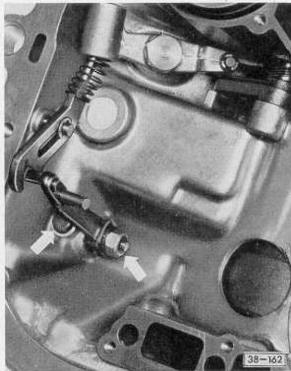
Abb. 2 Zapfenschraube heraus-schrauben und Hebelwelle für Seilzug herausziehen.
