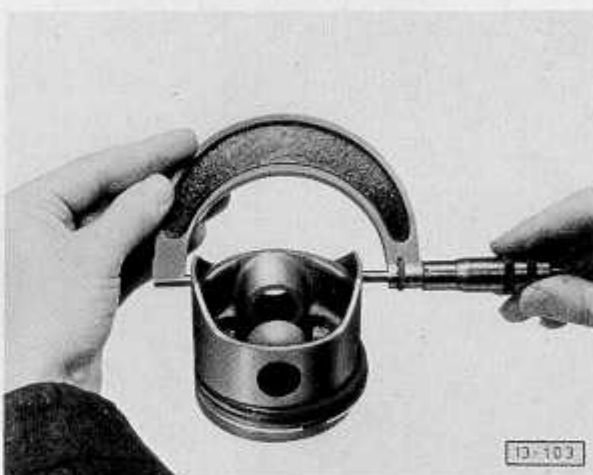
Abb. 6 Kolben \phi prüfen
