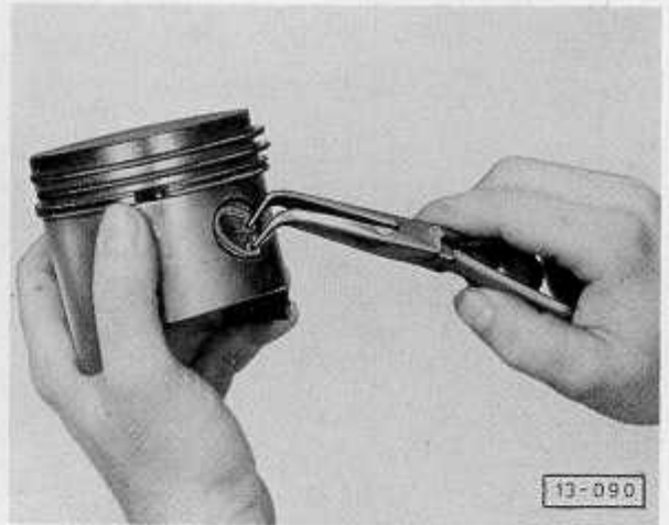
Abb. 4 Sicherungsring aus- und einbauen
