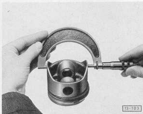
Abb. 6 Kolben \phi prüfen
