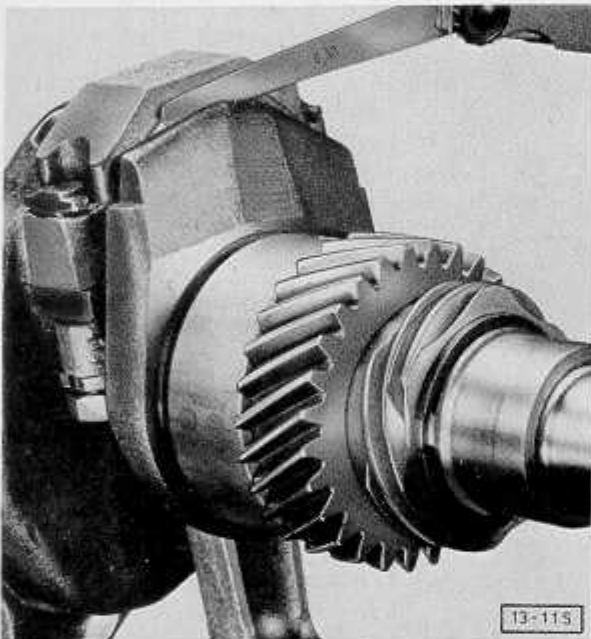
Abb. 12 Pleuelstange – Axialspiel prüfen max. 0,7 mm
