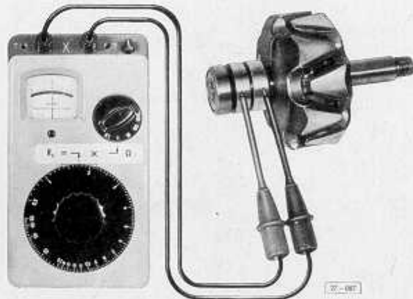
Abb. 9 Läufer/Wicklungsschluß bzw. Unterbrechung prüfen
