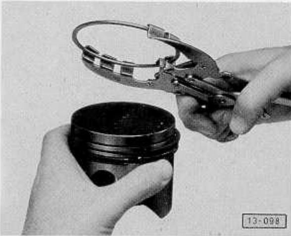
Abb. 1 Kolbenringe aus- und einbauen
