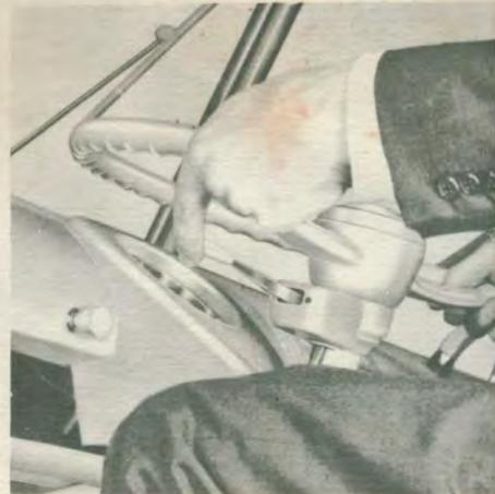
interruptor desligado ou na posição intermediária, a alavanca possibilita acionar o fecho alto para os sinais de luz.
